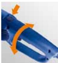
стопор шпинделя. spindle stop.
