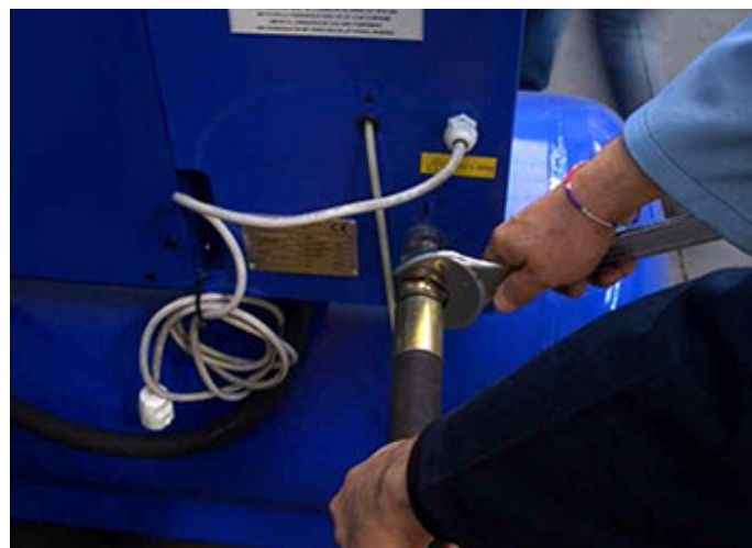
Подключение компрессора к пневматической магистрали
